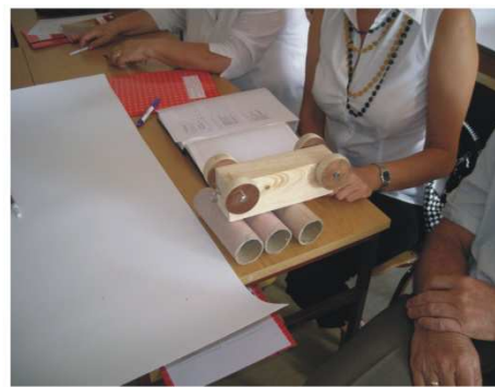
Слика 8.1 Огледи за утврђивање разлике између трења клизања и трења котрљања
